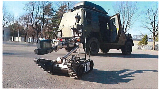
Figure 4 Robot d'exploration équipé d'un appareil de radiométrie portable
