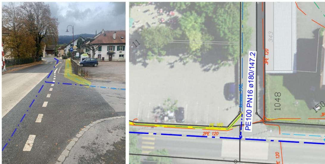
Figure 8 : Raccordement sur la conduite du chemin de Champ Collomb
